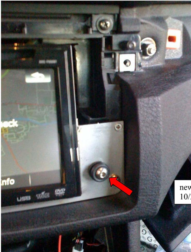
Beide beigefügten Abstandsschrauben mit Distanzgummi einschrauben und auf ca. 10mm Kopfabstand einstellen, die Blende aufsetzen und prüfen. Eine ideale Einstellung ist gefunden, wenn die Blende umlaufend genau bündig und ohne Tiefenabsatz mit dem Cockpit abschließt
