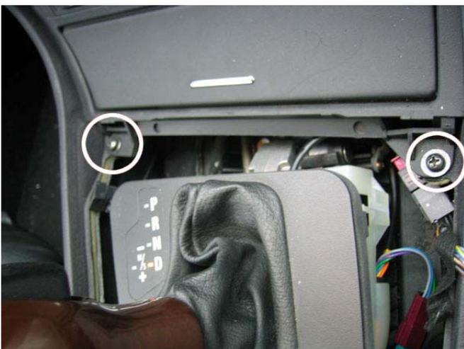
Bild 9: Schrauben unter dem Schaltrahmen
