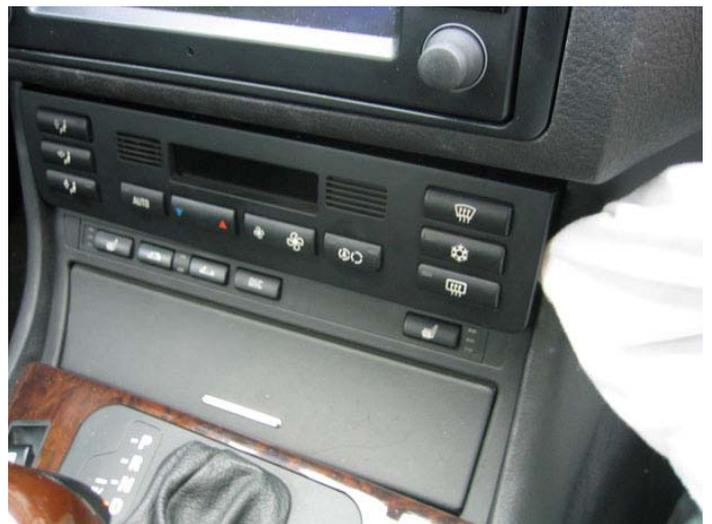
Bild 4: Klimaeinheit aushebeln
