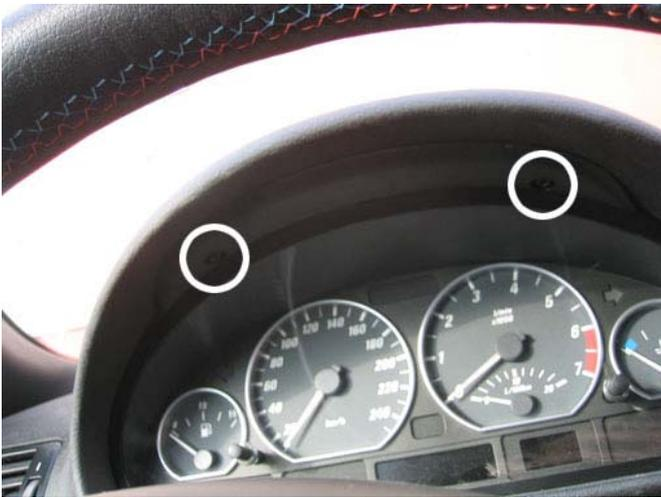
Bild 1: Schrauben Instrumentenkombiinheit
