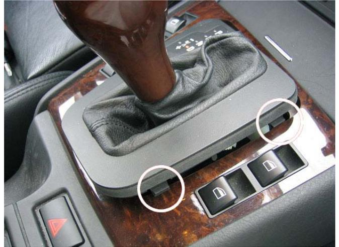
Bild 6: Schalthebelmanschette mit Klipsen
