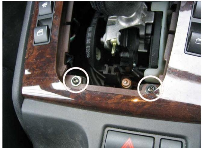
Bild 8: Schrauben unter der Schalthebelmanschette hinten
