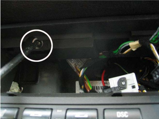
Bild 5: 2 Schrauben hinter Klimaeinheit lösen
