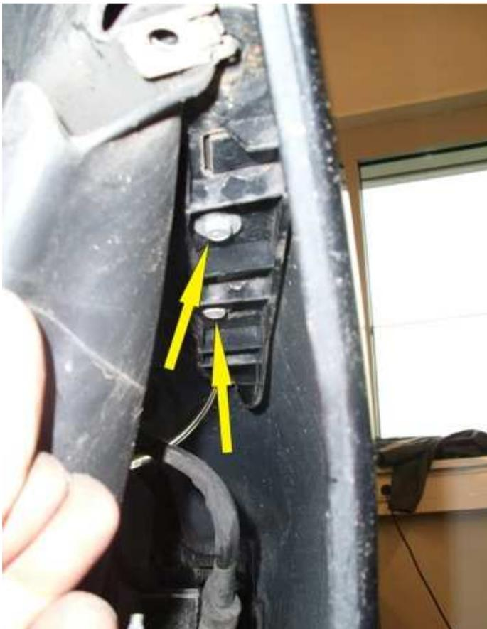
4. Drücken Sie jetzt mit z.B. einen Schraubendreher wie gezeigt, die drei Widerhaken nach unten und ziehen die Stoßstange seitlich nach außen, siehe nächstes Bild Nr. 4
