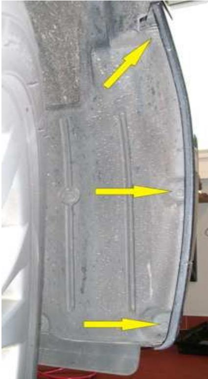
3. Die Radhaus-Innenverkleidung nach innen drücken und die zwei gezeigten Schrauben herausdrehen.
