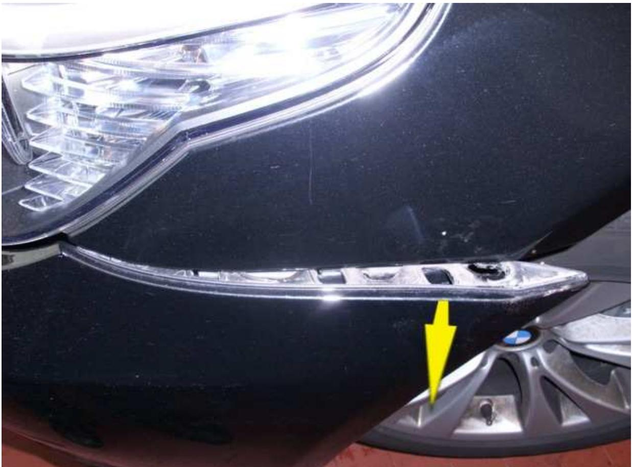
6. Entfernen Sie die gezeigten Schrauben rechts und links.
