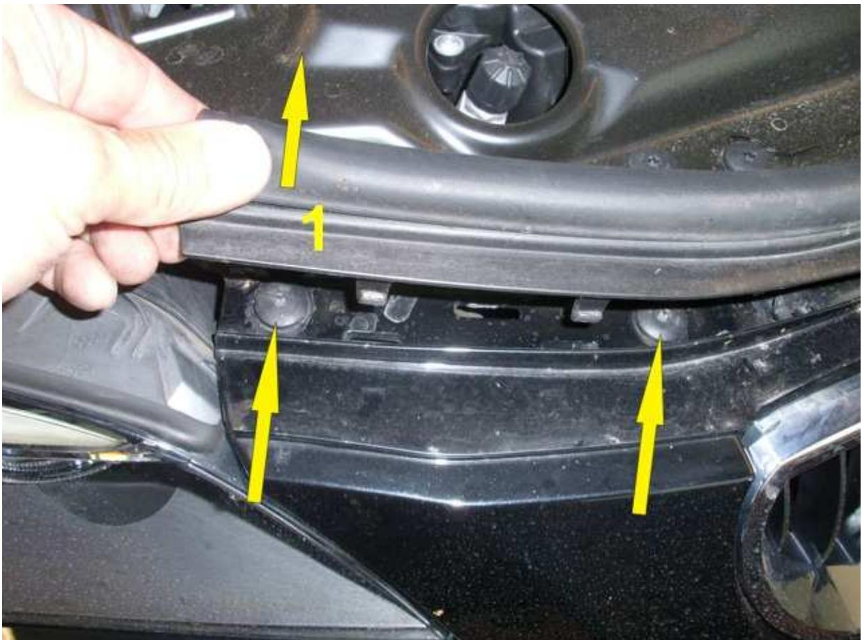
8. Jetzt sind alle Schrauben der Stoßstange entfernt und Sie können die Stoßstange nach vorne Ziehen - am besten mit einer zweiten Person.
