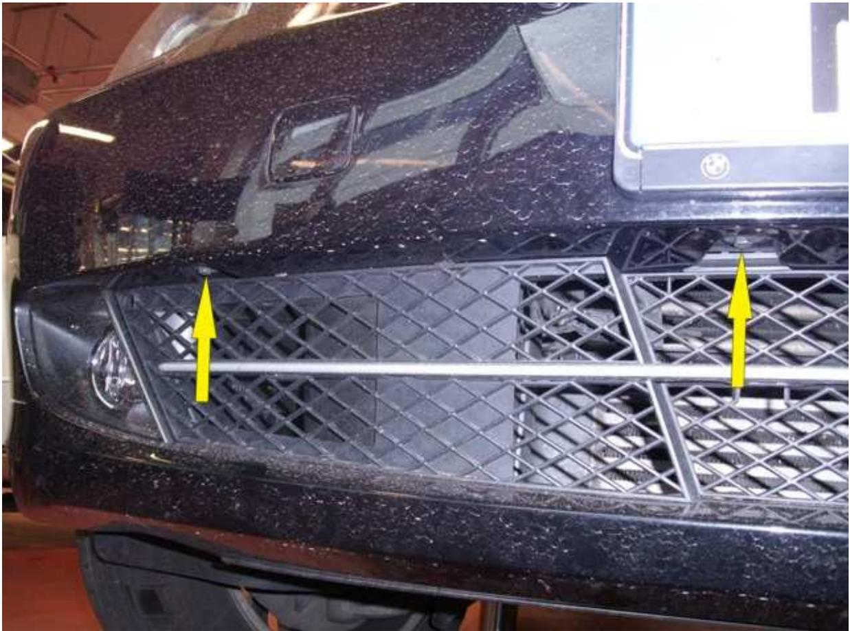
7. Ziehen Sie die Gummileiste ab und entfernen Sie die Schrauben.
