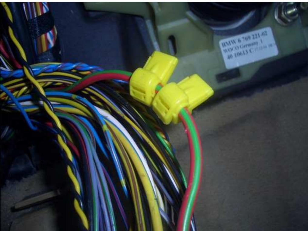
4. Verbinden Sie die beiden dicken roten Kabel vom Facelift-Modul mit Kabel Nr. 9.
