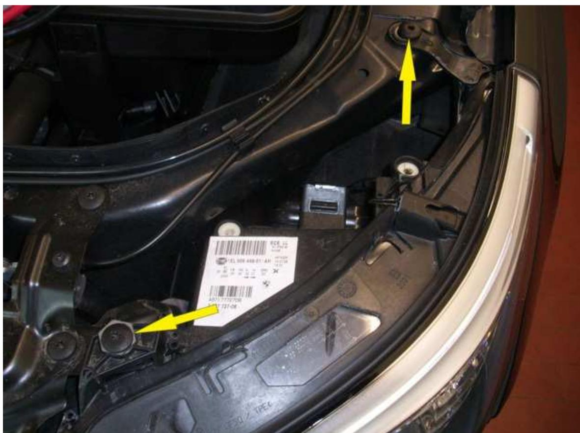
11. Jetzt sind alle Schrauben des Scheinwerfers entfernt und Sie können den Scheinwerfer nach vorne herausheben. Trennen Sie den Stecker am Scheinwerfer und legen Sie ihn zur Seite.
