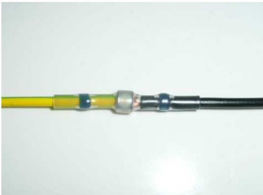
3. Lötverbinder zuerst an den Enden erwärmen.
