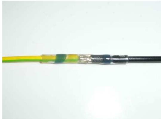
4. Lötverbinder in der Mitte erwärmen bis das Lötzinn vollständig verlaufen ist.
